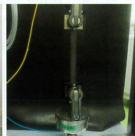
【伸び率試験状況 50mmの供試体が200mm以上に伸びた状況】
