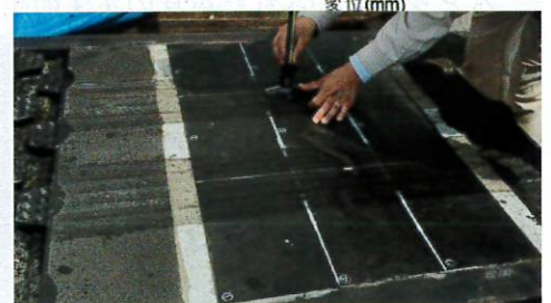
輪荷重試験 30年経過後検査
