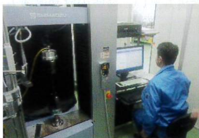
【伸び率試験状況 50mmの供試体が200mm以上に伸びた状況】
